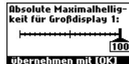
Die Maximalhelligkeit legt die (absolute) Helligkeit der an den jeweiligen Großdisplayausgang angeschlossenen Displays in [%] fest, die diese bei einer Spannung von 2,048 Volt am Helligkeits-Analogeingang haben sollen.
