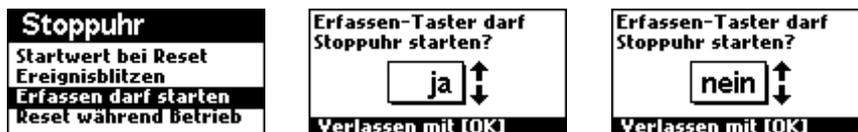
Steht nur eine Lichtschranke zur Verfügung, die sowohl für Start der Stoppuhr wie auch für die Erfassung von Zwischenzeiten eingesetzt werden soll, kann die Funktion „Erfassen darf starten“ genutzt werden. Sie ermöglicht das Starten der Stoppuhr mit dem Erfassen-Taster bzw. einer Lichtschranke, die auf die Erfassen-Funktion eingestellt ist.
