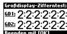
Um zu überprüfen, ob das Großdisplay mit allen LEDs korrekt funktioniert, können Sie die Displaytestfunktion verwenden. Es wird folgende feste Testabfolge auf beiden Großdisplayausgängen gezeigt:
