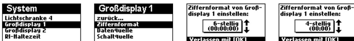
Dank des modularen Aufbaus der Großdisplays können Sie die Großdisplayziffern und Punkteleiten nach Ihren Bedürfnissen anordnen. Damit das Steuergerät diese Anordnung kennt und die Inhalte bestmöglich darauf darstellen kann, müssen Sie die von Ihnen gewählte Anordnung im Menüpunkt „Ziffernformat“ einstellen. Es stehen folgende Ziffernformate zur Auswahl:
