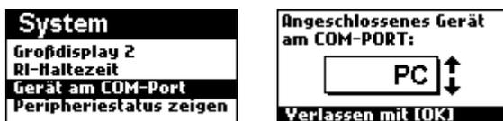
Die Funktion „Gerät am COM-Port“ legt fest, ob an der seriellen Schnittstelle des Steuergeräts ein ESC/POS-Thermodrucker oder ein PC angeschlossen ist. Ist ein Drucker angeschlossen, können sämtliche Druckfunktionen des Systems genutzt werden (Bon drucken, Profil drucken, etc). Ist ein PC angeschlossen, ist hingegen der Kommandozeileninterpreter aktiv und Sie können z.B. per Terminal mit dem Gerät kommunizieren.
