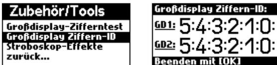
Diese Funktion dient zur Identifizierung einzelner Ziffernmodule an den Großdisplayausgängen. Auf jedem Ziffernmodul wird seine Adresse angezeigt. Um eine korrekte Funktion der Uhr zu gewährleisten, müssen die Ziffernmodule gemäß Ihrer Adresse so angeordnet sein, dass die kleinste Adresse rechtsbündig ist. Bezogen auf ein vier- oder sechsstelliges Display ergibt sich beispielsweise folgende Anordnung:
