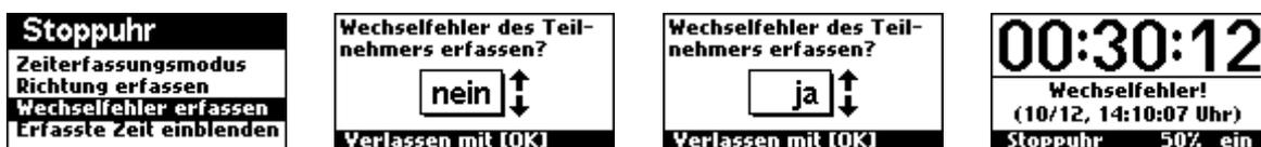
Bei einigen Sportarten muss der Teilnehmer immer abwechselnd von vorne und von hinten durch die Lichtschranke laufen. Tut er das nicht, also läuft zweimal in der gleichen Richtung durch die Lichtschranke, zählt dies als „Wechselfehler“. Ist die Funktion „Wechselfehler erfassen“ aktiviert und tritt dieser Fall ein, wird dieses Ereignis in der Ereignisliste als „Wechselfehler“ vermerkt.
